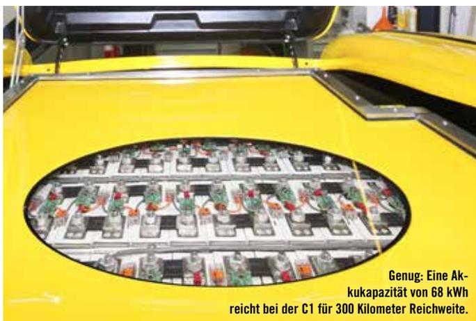
Genug: Eine Akkukapazität von 68 kWh reicht bei der C1 für 300 Kilometer Reichweite.
